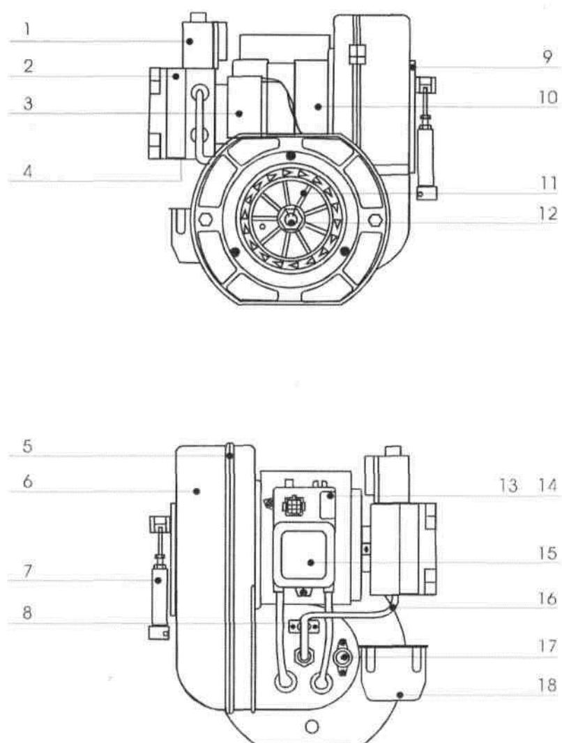
1. Катушка соленоидная топливного насоса
