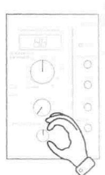
5. Установить регулятором «температура в комнате» желаемое значение обогреваемой температуры на отапливаемом объекте. (Рис. 16.4.)
