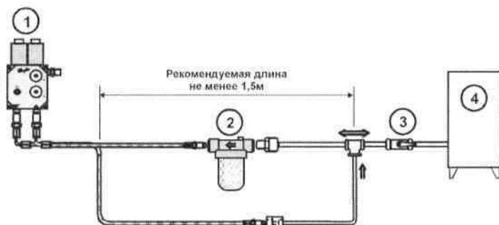
Рис. 33.2. где, 1-топливный насос; 2- топливный фильтр типа 40/50; 3-топливный кран 4-бак т.р.
