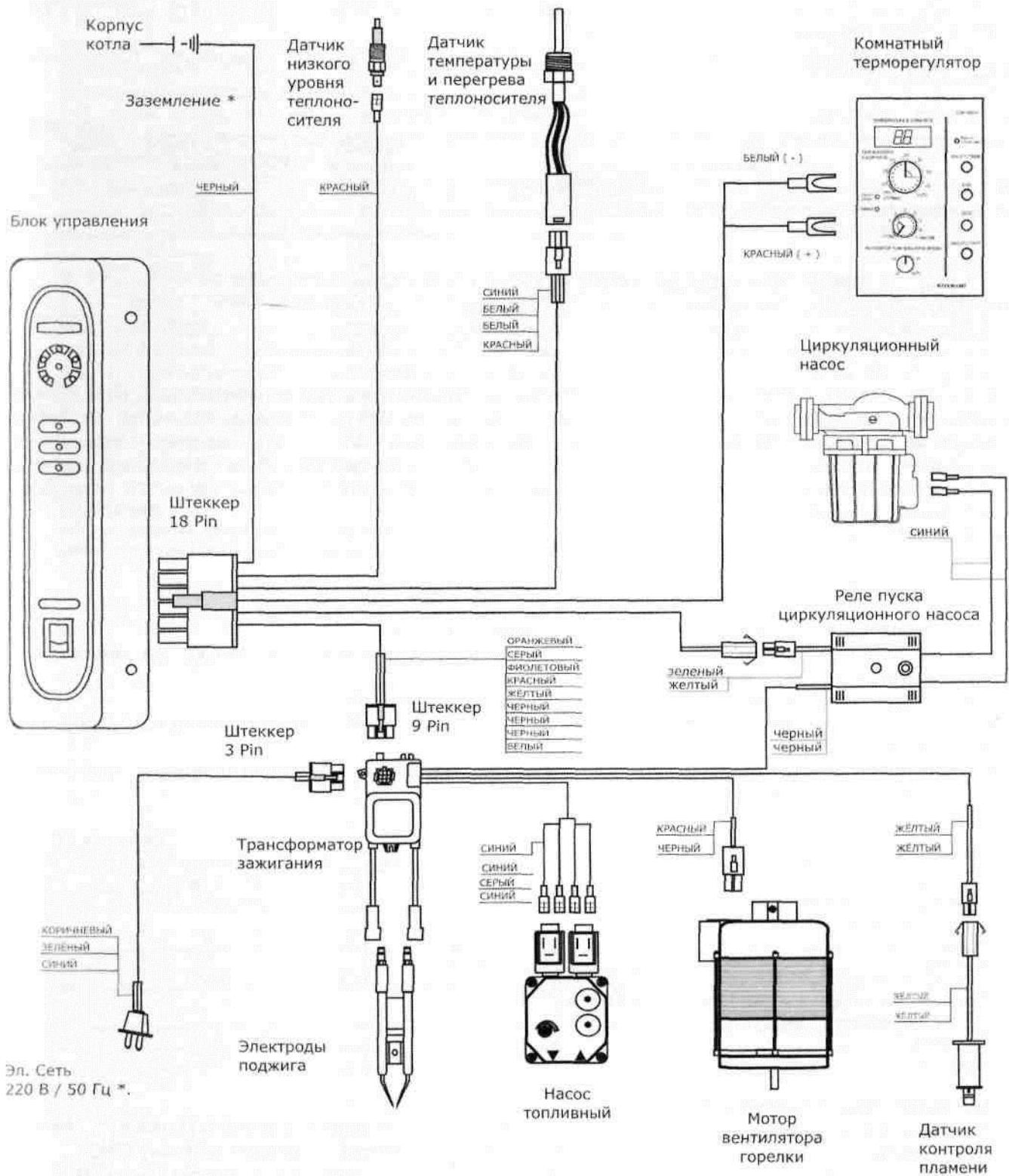
\* - Схему электрическую смотреть совместно с разделом подключение электропитания, глава "МОНТАЖ КОТЛА".
