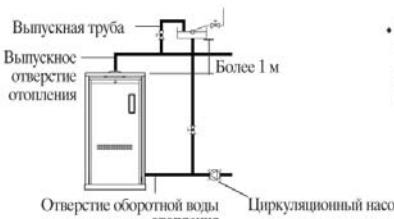
• Рекомендуется установить расширительный бак на высоте более 1 м от верхней части отопительного котла (при установке в подземном помещении установите на высоте более 1 м от высоты прокладки труб на полу помещения)
