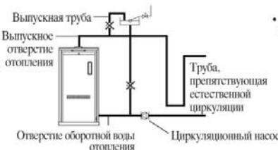
• Запрещается устанавливать какие-либо вентили на подающей трубе и выпускной трубе отопительного котла.
