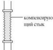
При прокладке труб отопления, если прямые участки труб слишком длинные, возникает явление растяжимости труб, вызываемое температурой обратной воды или могут образоваться трещины на сварочных швах. При удлинении прямых участков труб рекомендуется изогнуть средние участки труб коленом или установить компенсирующий стык, который примет на себя действие растяжимости.
