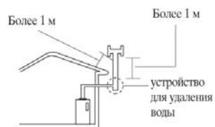
Рекомендуется устанавливать таким образом, чтобы избежать зоны давления ветра в верхней части дымовой трубы, защитить трубу от дождя и ветра.
