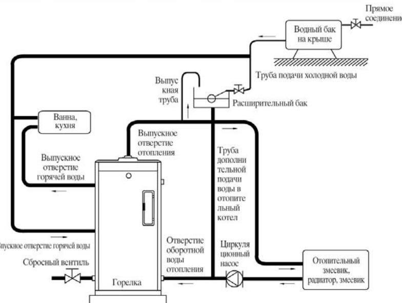
\* Впускное/выпускное отверстия горячей воды устанавливаются только на отопительном котле, предназначенном для отопления и снабжения горячей водой
