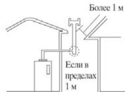
Если в пределах 1 м от дымовой трубы находится высокое здание или другое сооружение, рекомендуется устанавливать дымовую трубу выше более 1 м от крыши высокого здания.
