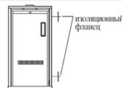
• При прокладке медных труб обязательно используйте изоляционный фланец на отверстии обратной воды отопления и выпускном отверстии отопления (в отопительном котле, предназначенном для снабжения горячей водой, – на выпускном отверстии горячей воды и отверстии обратной воды) (иначе может сократиться срок службы отопительного котла).
