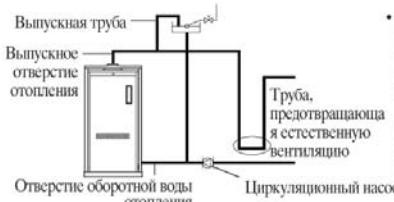
• Для предотвращения естественной циркуляции, вызываемой конвекционным действием, при прокладке отопительных труб горячей воды рекомендуется установить трубу, предотвращающую естественную циркуляцию. При прокладке труб отопления используйте предохранительное выпускное отверстие и выпускное отверстие отопления, которые позволят предотвратить разрушение отопительного котла вследствие расширительного давления.
