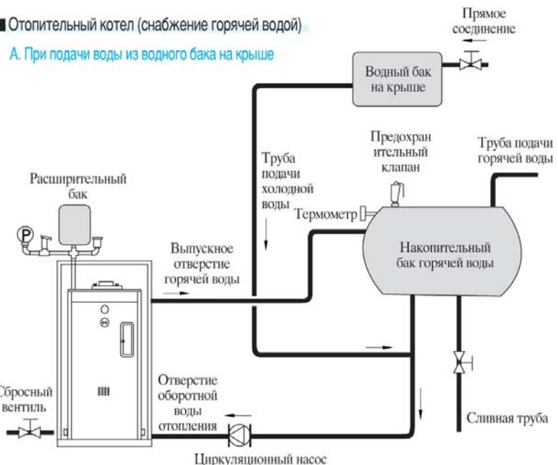
\* В отопительных котлах модели KS-50 и далее выпускное отверстие горячей воды устанавливается в верхней части отопительного котла.
