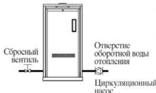
Технические характеристики циркуляционного насоса должны соответствовать объему обратной воды отопления. Рекомендуется установить сбросной вентиль.
