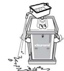
Рекомендуется устанавливать отопительный котел горизонтально на бетонном или кирпичном основании
